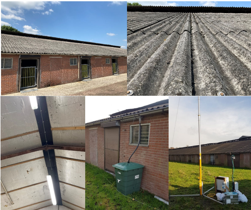
Figuur B9. Overzichtfoto's van de meetlocatie Hoevelaken-2 met het asbestcement dak van de kalverenschuur (boven), het interne dakoppervlak van de schuur met stalen en houten dakspanten (linksonder), de uitspoeling meetopstelling naast de kalverenschuur (midden onder) en de windrichting-aangestuurde meetopstelling benedenwinds van de twee schuren (rechtsonder).
