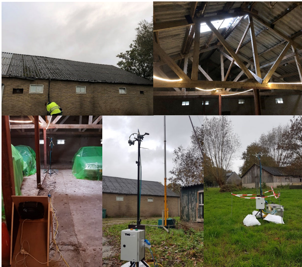
Figuur B5. Overzichtfoto's van de meetlocatie Hoevelaken-1 met de voormalige veeschuur inclusief de installatie van de uitspoelingsopstelling (linksboven), het interne dakoppervlak van de veeschuur met houten dakspanten (rechtsboven), de luchtmeting met actieve ventilatie in de veeschuur (linksonder) en de windrichting-aangestuurde meetopstellingen boven- en benedenwinds van de veeschuur en kippenschuur (midden- en rechtsonder).
