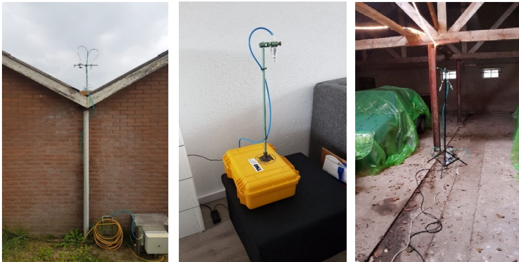
Figuur 9: Representatieve opstelling continue luchtmetingen (links) buiten meetlocatie Barneveld, (midden) binnenhuis locatie Lelystad-1 en (rechts) binnen in schuur locatie Hoevelaken-1.
