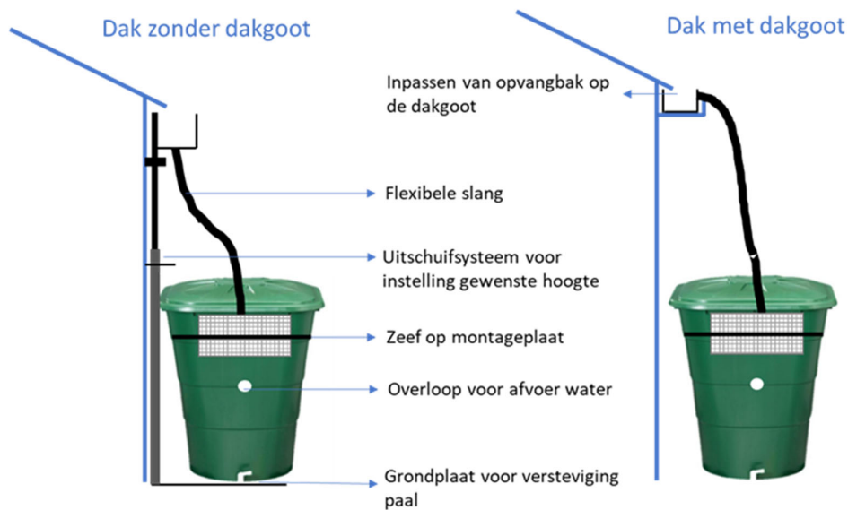
Figuur 2: Schematisch weergave van het regenwater opvangsysteem voor (links) een dak zonder dakgoot en (rechts) een dak met dakgoot.
