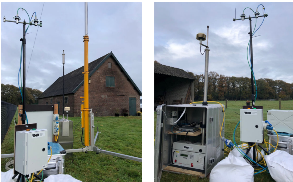
Figuur 10: Representatieve opstelling windrichting-aangestuurde luchtmetingen (links) benedenwinds met een Dust Monitor in de metalen box en (recht) bovenwindse opstelling op meetlocatie Loenen.
