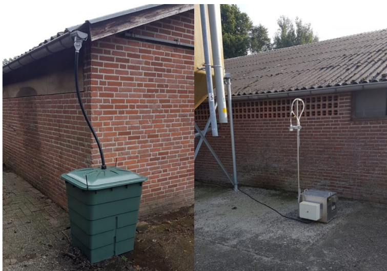
Figuur B25. Luchtmeting (links) en uitspoelingsmeting (rechts) op meetlocatie Barneveld
