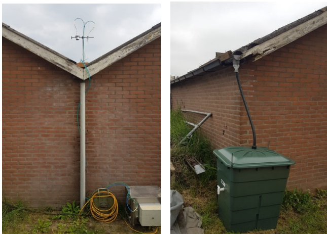
Figuur B2. Luchtmeting (links) en uitspoelingsmeting (rechts) op meetlocatie Barneveld
